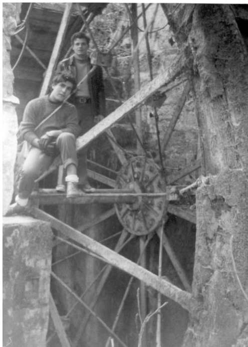
FIGURA nº5: Rueda hidráulica de la fábrica de Sanus
